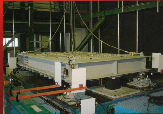
鉛直動をも考慮した振動台実験
